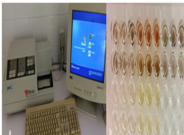
**FIGURA 2** - Determinação da atividade antimalárica. a) Equipamento de leitura espectrofotométrica e registo de resultados b) microplaca.
